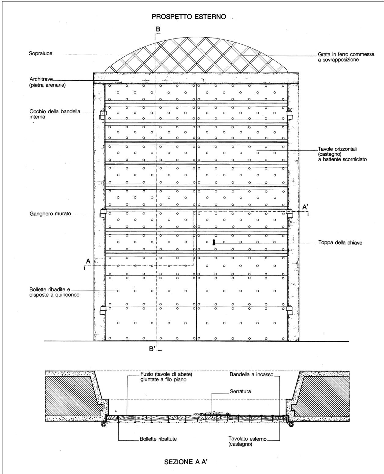
ESEMPIO DI PORTA A DUE ANTE CON SPECCHIATURE GEOMETRICHE E SOPRALUCE
