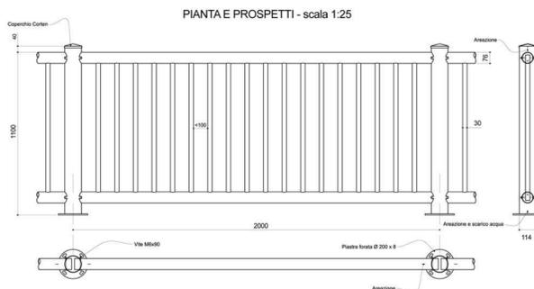
DETTAGLIO ANCORAGGIO PARAPETTO
